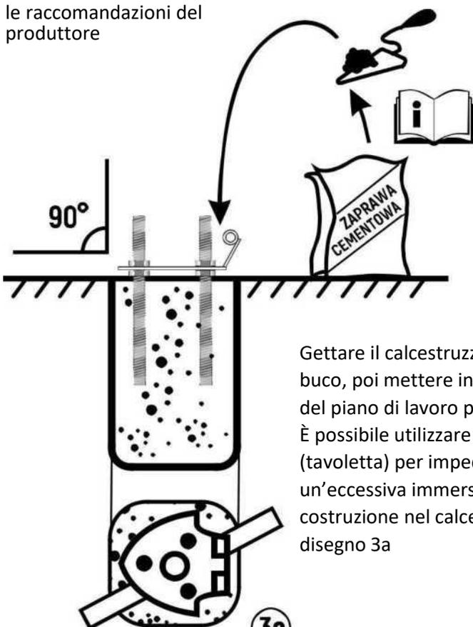
Gettare il calcestruzzo nel buco, poi mettere in esso il kit del piano di lavoro preparato. È possibile utilizzare asse (tavoletta) per impedire un'eccessiva immersione della costruzione nel calcestruzzo - disegno 3a
